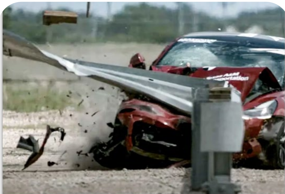
Chockbilder: Så kollapsar vägräcket av en elbil
